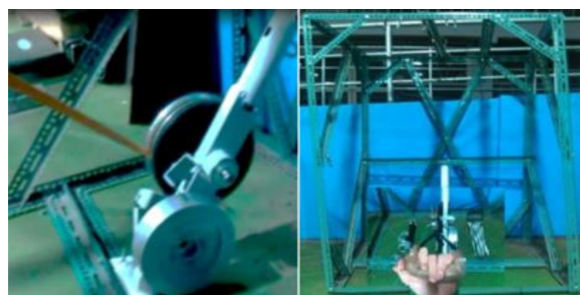
圖一、複合式阻力源供應機台(以慣性輪為例)
