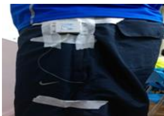
圖一、三軸加速規擺放位置
