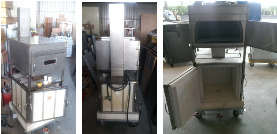
圖 6 行動樂燒窯烤爐外觀與使用示意圖
