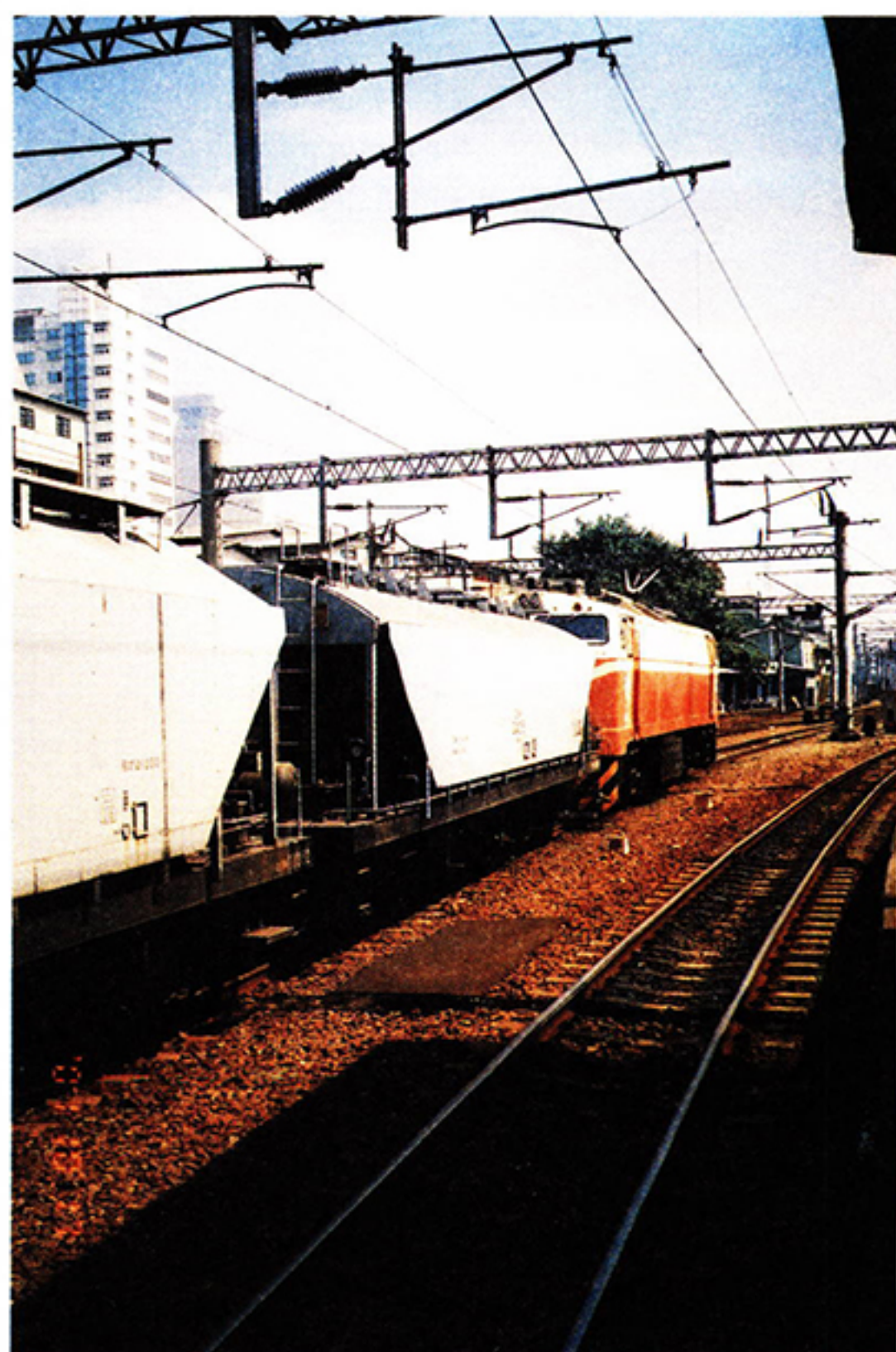
台鐵貨車機車頭及載送貨物情形（圖示車廂皮重19.40公噸，載重35公噸）
