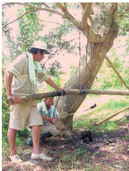
圖7 以石頭的重力彎曲竹子 (黃菁瑩攝)
