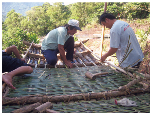
圖9 編製海上用筏的筏面竹蓆 (黃菁瑩攝)
