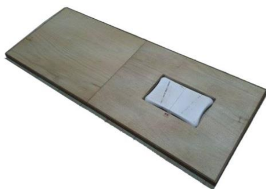
圖3 Wii board 固定板
