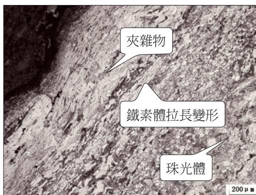
圖二十五：天津大沽砲臺展覽的清軍雙 層體鐵砲砲尾中心鐵棒樣品 (Dg7-w)邊部金相圖
